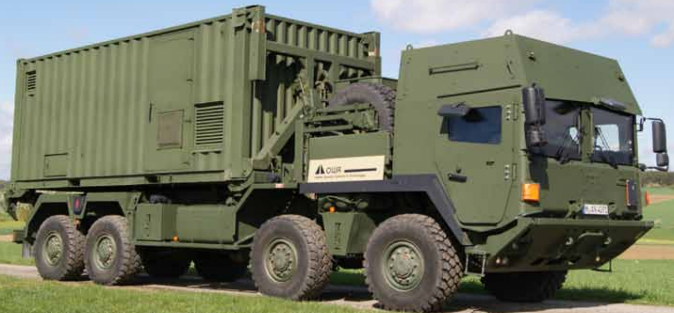
Multipurpose Decontamination System MPD100i auf geschütztem MAN SX
