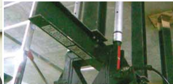
Project: testen van balken met een custom made lichtgewicht testunit. Lokatie: Kerncentrale Frankrijk
