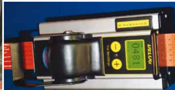
Noviteit: Spankrachtmeter op spanbanden; altijd stevig vastgesjord.
