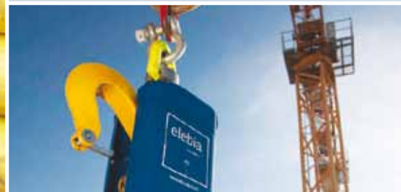
Noviteit: Elektrisch op afstand te openen lasthaak voorkomt onnodig klimwerk om lading te lossen.
