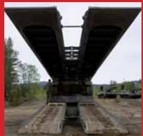
Bruglegger met op de achtergrond nog 2 bruglegendende systemen zonder brug
