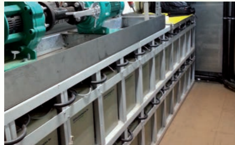
COMPONENT 2 Batterijpakket (Lithium-Polymeer batterijen van EST-Floattech) foto: EST-Floattech
