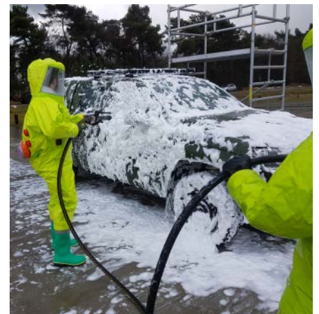
Radioloische ontsmetting met schuim om de radioactieve deeltjes te 'vangen' en af te spoelen
